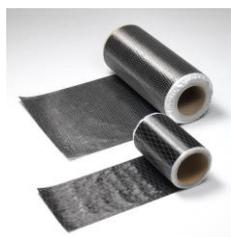
S&P C-Sheet 240 ist ein unidirektionales Carbonfaser-Gelege mit hoher Festigkeit für die Tragwerksverstärkung im Trocken- oder Nassverfahren. Die S&P C-Sheets werden mit Epoxidharzkleber (S&P Resin 55 oder S&P Resicem) mit dem zu verstärkenden Bauteil verklebt.
