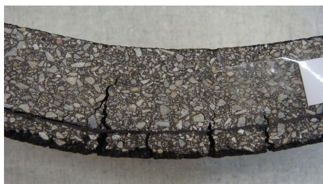
2 provino di riferimento con armatura S&P Carbophalt 200 kN
